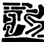
Bild 10. Geätzte Platine des Verstärkers in Originalgröße
